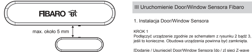
Schemat 4 - Prawidłowe ułożenie magnesu względem czujnika
